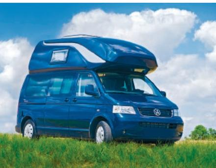
Alkoven-Hochdach für den VW T5 mit langem Radstand
