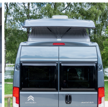
Die Gesamthöhe des Fahrzeug bei geschlossenem Schlafdach beträgt rund 255 cm
