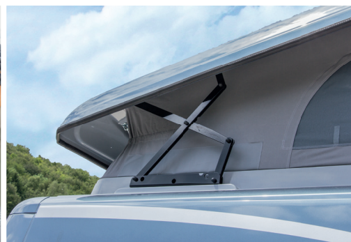
Die 45 cm hohen Aufstellscheren bieten sehr viel Beinfreiheit bzw. ermöglichen eine Schlafposition mit Kopf nach hinten.
