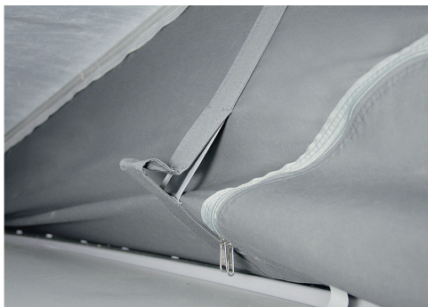
Der Einklappmechanismus zieht den Stoffbalg beim Schließen der Dachschale automatisch nach innen.
