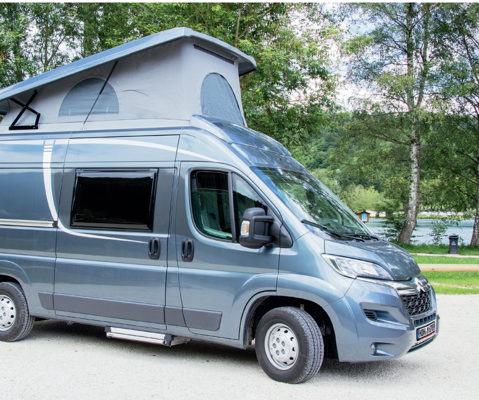
Aerodynamische Anbindung des GFK-Spoilers an das Basisfahrzeug
