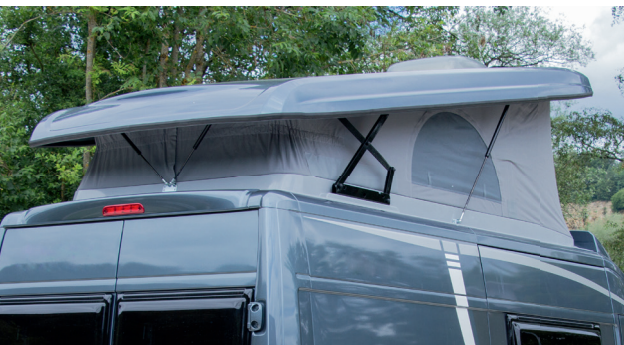
Leichtes und unkompliziertes Aufstellen des Dachs durch zwei hohe Aufstellscheren und vier Gasfedern
