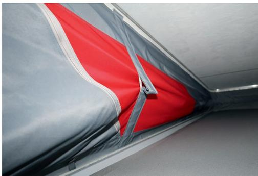
Der Einklappmechanismus zieht den Stoffbalg beim Schließen der Dachschaale automatisch nach innen.
