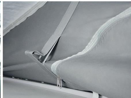
Einklappmechanismus bei allen Dächern, der den Stoffbalg beim Schließen der Dachschalen nach innen zieht
