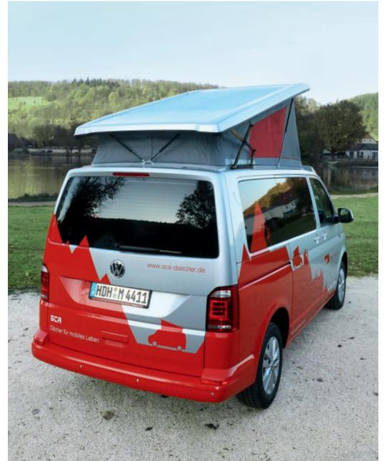
Auf die glatte Außenfläche der Dachschale lassen sich Solarmodule bzw. -folien anbringen.
