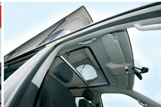
In das aufgestellte Dachbett gelangt man bei vorne aufgestellten Dächern durch die Durchstiegsöffnung über den Vordersitzen.
