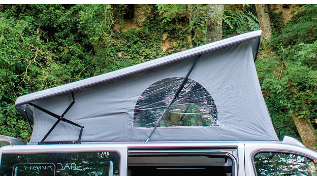
Die 45 cm hohen Aufstellscheren schaffen zusätzliche Beinfreiheit oder ermöglichen eine Schlafposition mit Kopf nach hinten.
