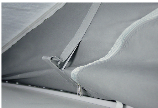
Der Gewebe-Stoffbalg wird dank eines praktischen Klappmechanismus bei Schließen der Schale automatisch nach innen geklappt.
