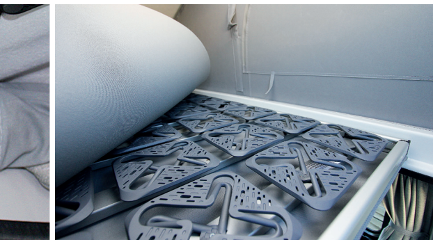
Komfortable Liegeeinrichtung mit flexiblen Kunststoff-Federelementen und Alurahmen
