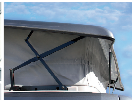
45 cm hohe Aufstellscheren bieten wesentlich mehr Beinfreiheit bzw. ermöglichen eine Schlafposition mit Kopf nach hinten.
