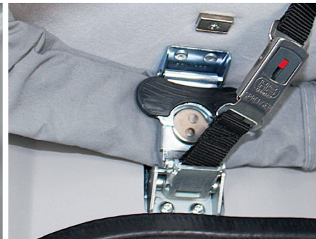
Einfache und sichere Verriegelung des Dachs mit zwei Southco-Verschlässen und integriertem Zusatz-Sicherheitsriemen
