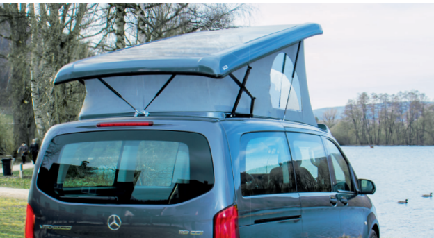
Leichtes Aufstellen durch zwei Aufstellscheren und vier Gasfedern
