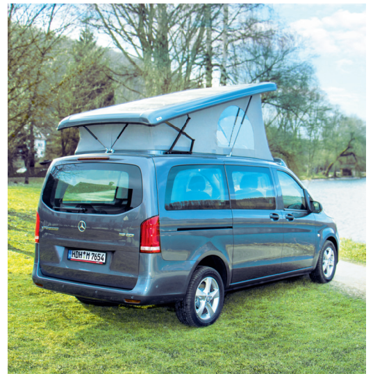
Auf die glatte Außenfläche der Dachschiele lassen sich Solarmodule bzw. -folien anbringen.
