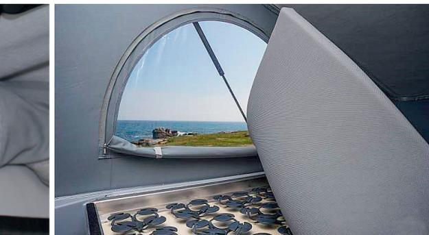
Komfortable Liegeeinrichtung mit flexiblen Kunststoff-Federelementen und Alurahmen
