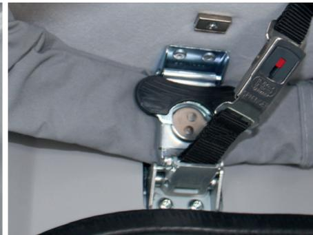
Einfache und sichere Verriegelung des Dachs mit zwei Southco-Verschlüssen und integriertem Zusatz-Sicherheitsriemen
