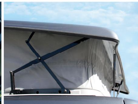
45 cm hohe Aufstellscheren bieten wesentlich mehr Beinfreiheit bzw. ermöglichen eine Schlafposition mit Kopf nach hinten.
