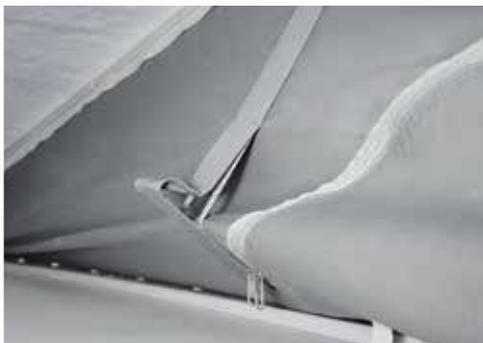
Der Einklappmechanismus zieht den Stoffbalg beim Schließen der Dachschaale automatisch nach innen.
