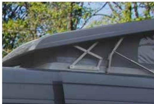
Die 45 cm hohen Aufstellscheren bieten sehr viel Beinfreiheit bzw. ermöglichen eine Schlafposition mit Kopf nach hinten.
